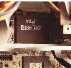
Il microprocessore 2096DX250. Un die di 614 millimetri a 50 MHz ed esterno a 25 MHz
